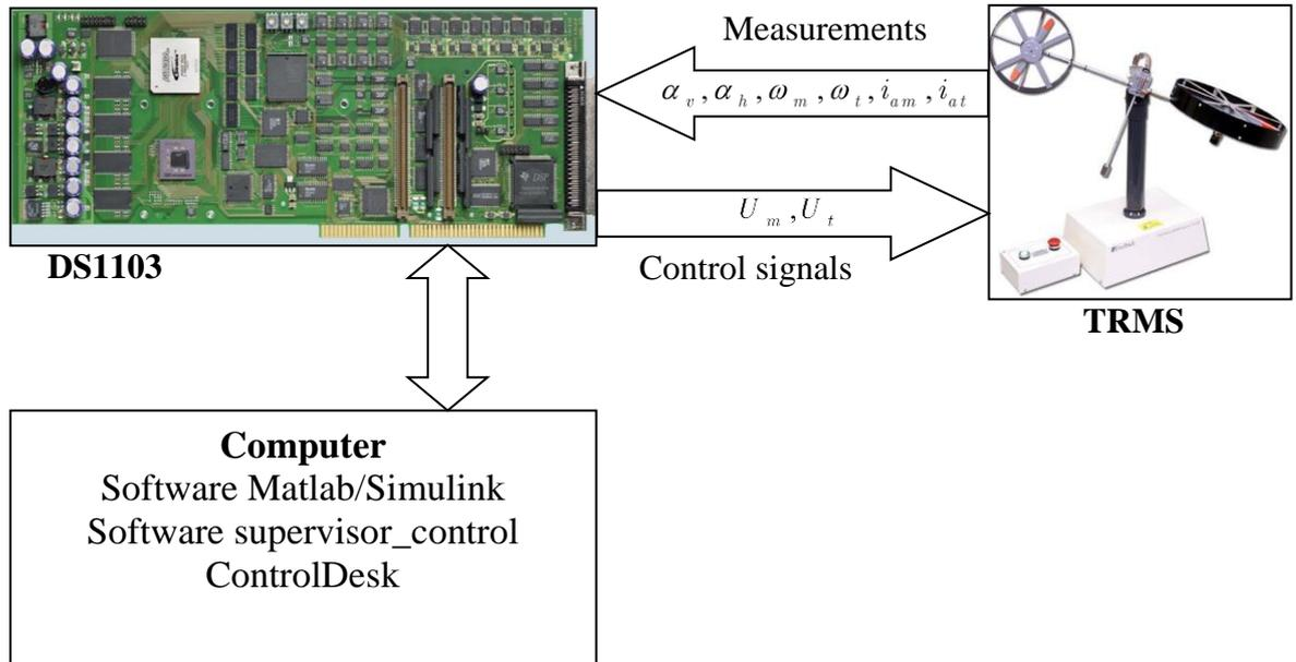
Figure 4.2. Control structure for TRMS using DS1103
